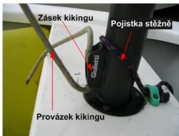
Obr. 12 Kiking a regulace napětí předního lemu
