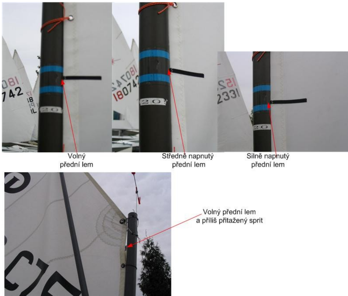
Obr. 18 Seřízení napětí předního lemu
