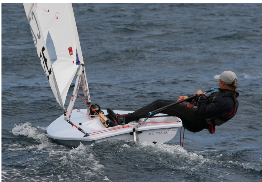
Obrázek 5: Podle úhlu otěží můžeme poznat nastavení kikingu. Zde je přitážen více než block to block, tedy na vítr, kdy už potřebujeme občas povolit, ale ještě nepotřebujeme výrazně snižovat výkon.
