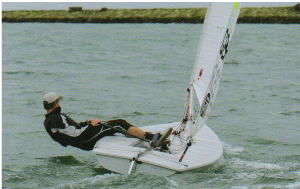
Obrázek 4: Správné nastavení plachty na střední vítr, kiking block to block
